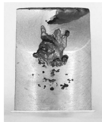
Fig. 9. The longitudinal section of the riser
