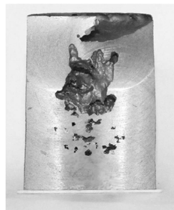
Fig. 9. The longitudinal section of the riser
