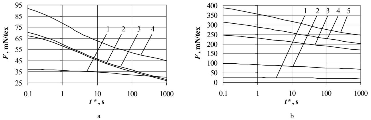
**Fig. 2.** Stress relaxation curves of the yarns. a – CA yarn;  $\varepsilon_t$ : 1 – 1 %, 2 – 5 %, 3 – 9.1 %, 4 – 22.1 % (mode II); b – PES yarn;  $\varepsilon_t$ : 1 – 1 %, 2 – 5 %, 3 – 10 %, 4 – 14.4 %, 5 – 32.1 % (mode II)
