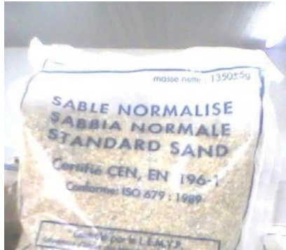
Fig. 3. Standard sand EN 196-1
